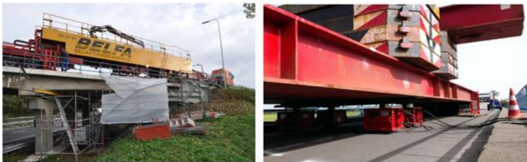
Hình 1. 12 (Trái) Xe thử tải của BELFA trên cầu cạn Vlijmen-Oost- (Phải) Hệ thống kích thủy lực thử tải bằng chứng cầu cạn Zijlweg [44] .
