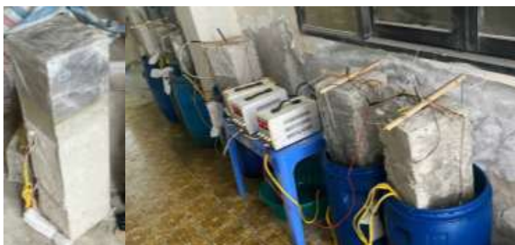
Hình 3.37: Thí nghiệm gia tốc ăn mòn
