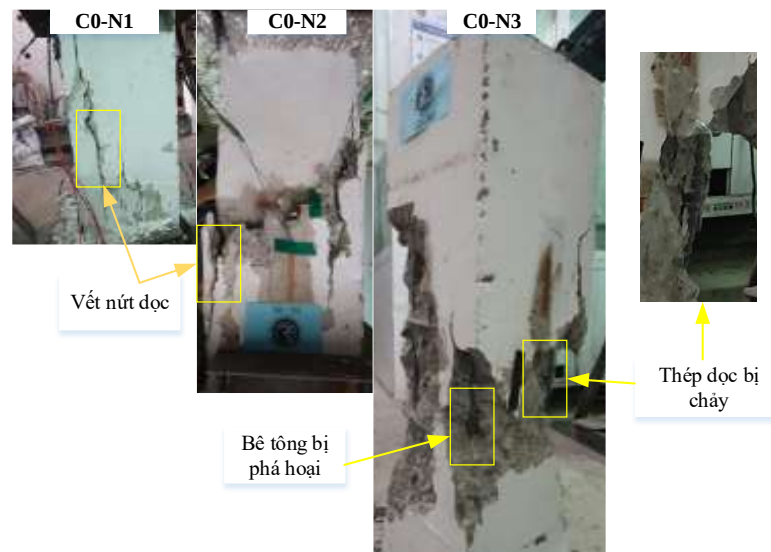
Hình 3.14: Dạng phá hoại của cột đối chứng C0-N1, C0-N2 và C0-N3 (cột không bị ăn mòn)
