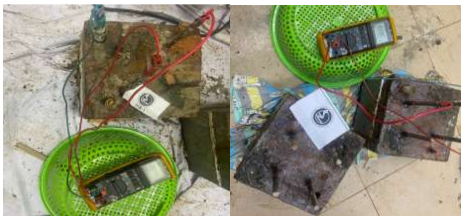
Hình 3.32: Thí nghiệm đo thế mạch hở của các mẫu thí nghiệm
