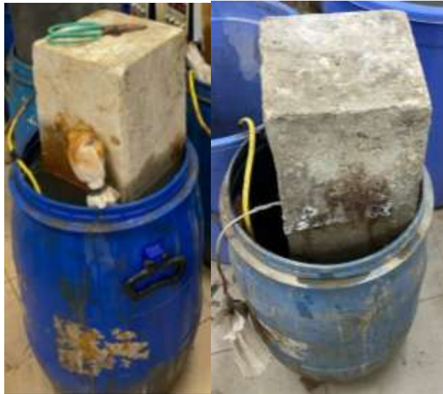
Hình 3.38: Cột bê tông trong chu kỳ ướt và chu kỳ khô
