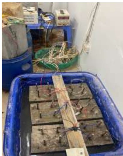
Hình 3.31: Gia tốc ăn mòn các mẫu thí nghiệm
