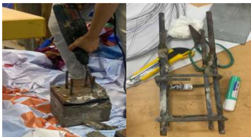
Hình 3.33: Thí nghiệm cân lượng thép còn lại
