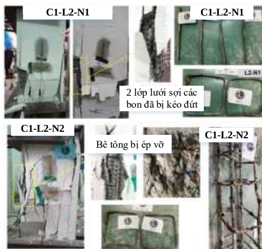
Hình 3.17: Dạng phá hoại của cột C1-L2-N1, C1-L2-N2 (cột bị ăn mòn, tăng cường 2 lớp BTCLD)
