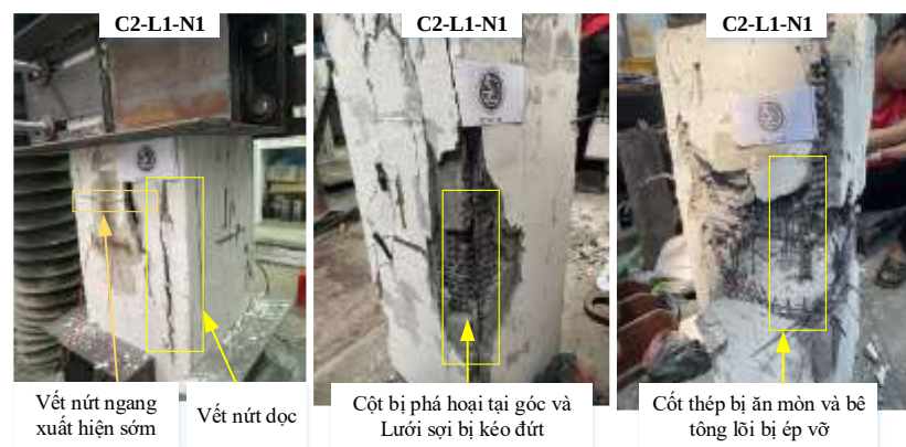
Hình 3.23: Dạng phá hoại của cột C2-L1-N1, C2-L1-N2 (ăn mòn 22%, tăng cường 1 lớp BTCLD)
