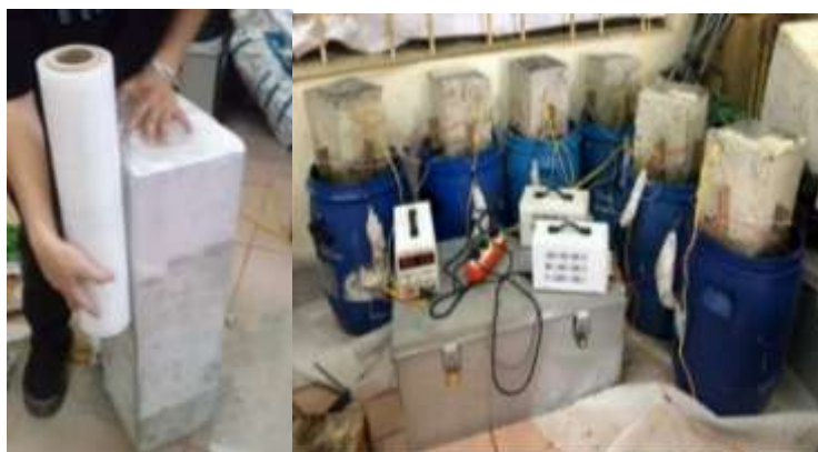
Hình 3.6: Thí nghiệm gia tốc ăn mòn
